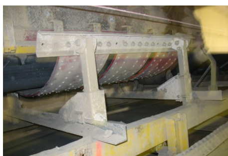
Gold ore - 500 tons per hour 1.200 Belt
